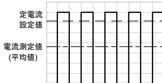
**逆電流：回生負荷** 本製品の出力がトランスやインバータのような回生型の負荷に接続されている場合、本製品へ電流が戻されるように電流が流れますが、本製品は逆電流を吸い込むことができません。逆電流を生じる負荷の場合は、本製品の出力に並列に抵抗を接続して逆電流をバイパスしてください。
