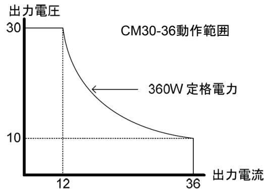
本製品は、出力電力(出力電圧×出力電流)が定格電力容量よりも小さい時に、一般的な定電圧、定電流の電源として機能します。
