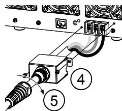
5. 電源コードの保護シースを時計回しで電源入力カバーに取り付けます。
