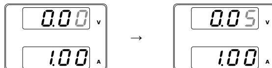
3. 1.00 V の桁が明るく表示されるまで、電圧つまみを繰り返し押します。(明るく表示される桁の数値が変更可能です。)
