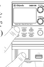
2. 電源投入時設定にて、F-93(マスタ・スレーブ設定) をそれぞれの機器に対して設定します。
