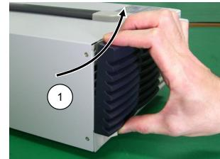
2. カバーパネル裏のエアフィルタを取り外して清掃してください。交換する場合は、オプションのエアフィルタ(大) (10YTPA0012076)を使用してください。
