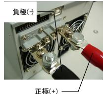
**リモートセンシングの接続** センス端子(+)と負荷端の(+)端子、およびセンス端子(−)と負荷端の(−)端子をそれぞれリモートセンシングケーブルで接続します。(リモートセンシングケーブルには電流が流れませんので、AWG20 程度の線径の線材を使って負荷端へ接続してください。)
