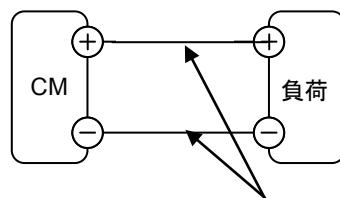
正極側のケーブルと負極側のケーブルを撲る(ツイストする)
