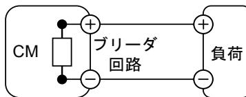
ブリーダ回路は、出力 OFF または電源スイッチ OFF したときに、本製品の出力部のコンデンサの電荷を放電して安全な電圧にするためのものです。
