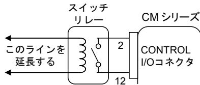
複数台の機器を 1 つの信号で制御する場合は、各機器への信号をリレーなどで絶縁して入力してください。
